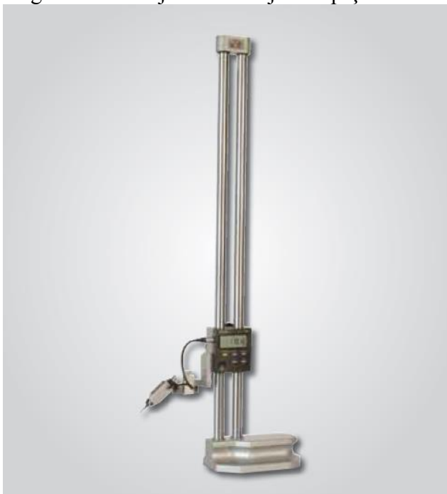
DIGIMATIC augstuma mēritājs kolonnas veidā
