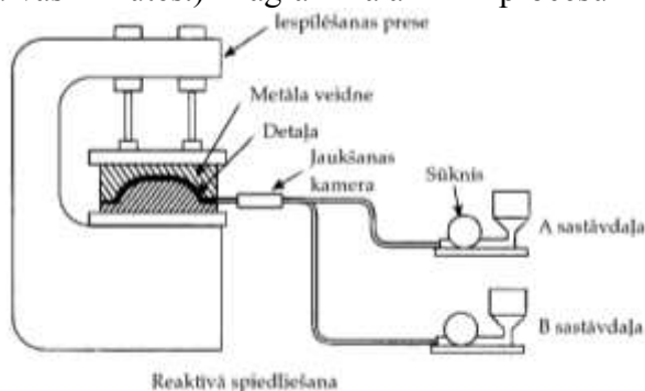
7.16. attēls. Reaktīvās spiedielišanas shēma.
